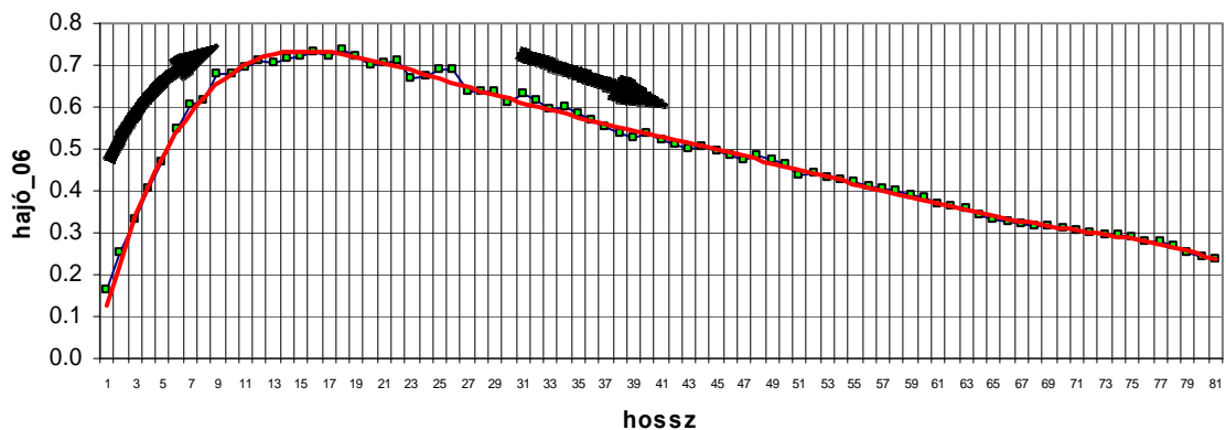
Menetnyomás-görbe az UTH testnél, javítás után
