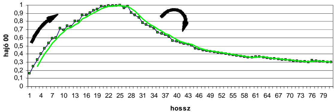
Menetnyomásgörbe UTH testnél javítás előtt
